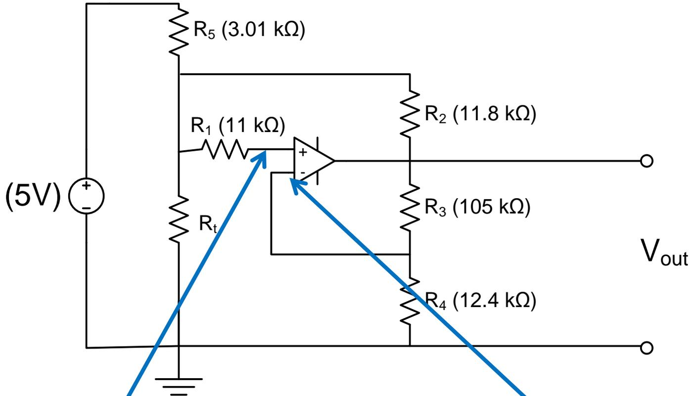
$$V_+ = V_{out} \frac{R_5 // R_t}{R_5 // R_t + R_2} + V_1 \frac{R_2 // R_t}{R_2 // R_t + R_5} \quad V_- = V_{out} \frac{R_4}{R_3 + R_4}$$
